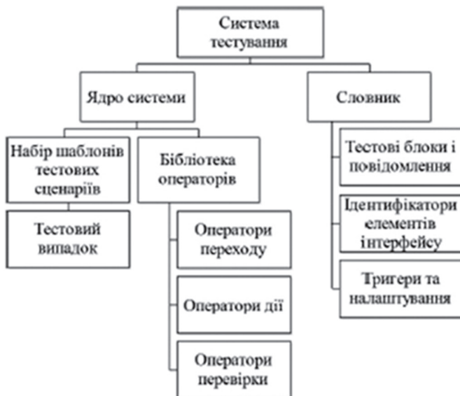
Рис. 2. Структура системи автоматичного тестування з використанням шаблонів
