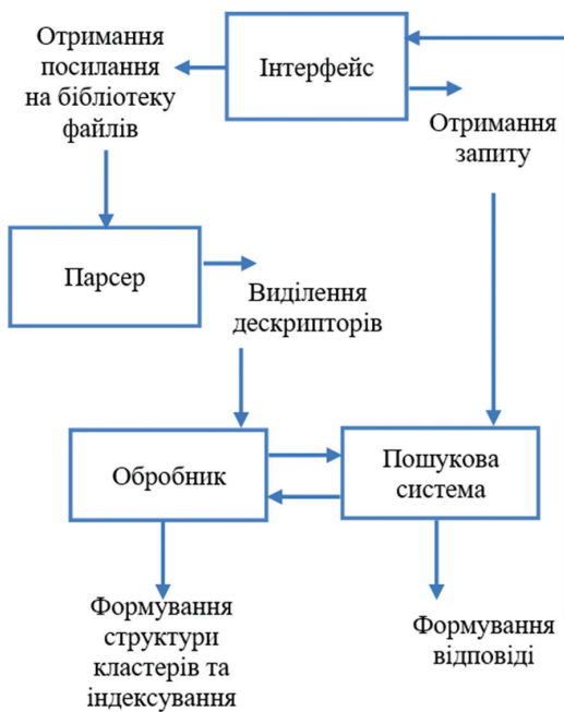
Рис. 3. Схема передачі даних в модулі «CLASTFIND»
