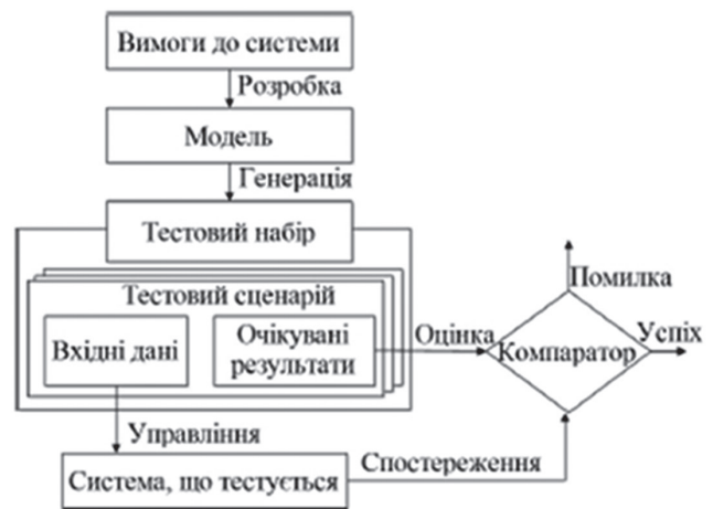
Рис. 1. Генерація сценаріїв тестування на основі моделі веб-застосунку
