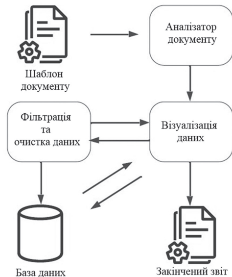
Рис. 8. Потік даних в системі генерації звітності медичних закладів
