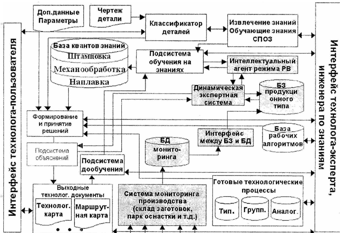
Рис. 3 Функциональная схема интеллектуальной системы поддержки принятия решений «КВАНТ+» для технологической подготовки авиационного производства
