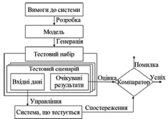
Рис. 1. Генерація сценаріїв тестування на основі моделі веб-застосунку
