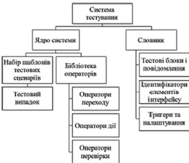
Рис. 2. Структура системи автоматичного тестування з використанням шаблонів
