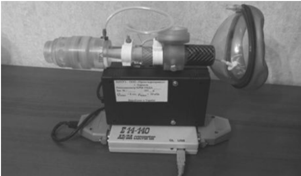
Рис. 2. Устройство для тестирования респираторных нарушений обоняния [9]
