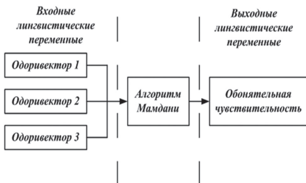
Рис. 3. Структура модели нечеткого вывода «Ольфактометрия»
