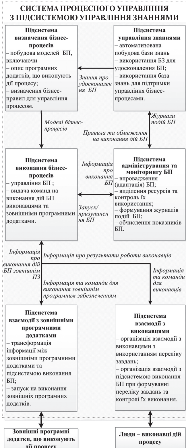
Рис. 1. Структура ІСПУ з підсистемою управління знаннями
